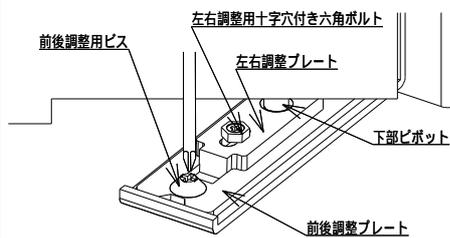
**お願い** 吊り元側には 4 mm 程度の調整が可能です。寄せ過ぎると、開閉時に建具が下部ピボット受けに接触して傷つく恐れがあります。開閉時に建具と下部ピボット受けが接触しない位置で調整してください。
