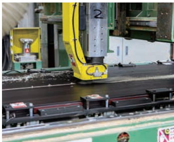
室内ドア 加工工程(中央スリット入れ)
