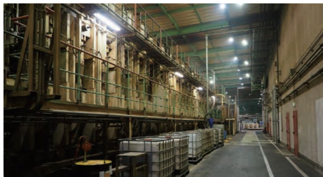
ドイツ・ディフェンバッハ社製連続プレス(長さ30m)
