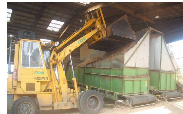
パーティクルボード生産のためのチップ投入口
